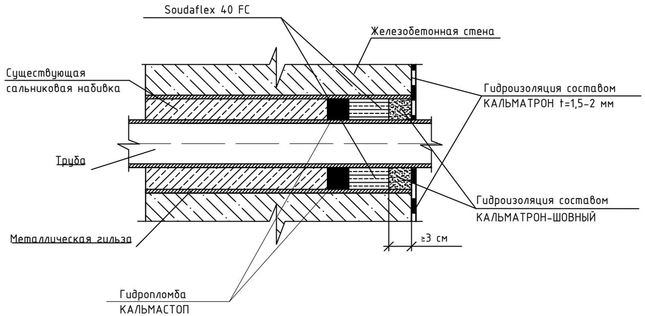
Soudaflex 40 FC – высококачественный, однокомпонентный полиуретановый герметик с высоким модулем упругости, подходящий для множества задач по склеиванию и герметизации.
